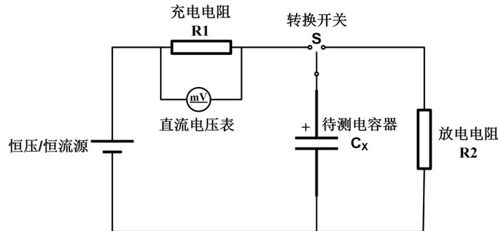
将开关 S 切换到放电电阻 R<sub>2</sub> 一侧，通过 R<sub>2</sub> 对待测电容 C<sub>X</sub> 进行放电。为了实现完全放电，放电时间不低于 1h，放电电阻 R<sub>2</sub> 参照下述公式进行选择：
